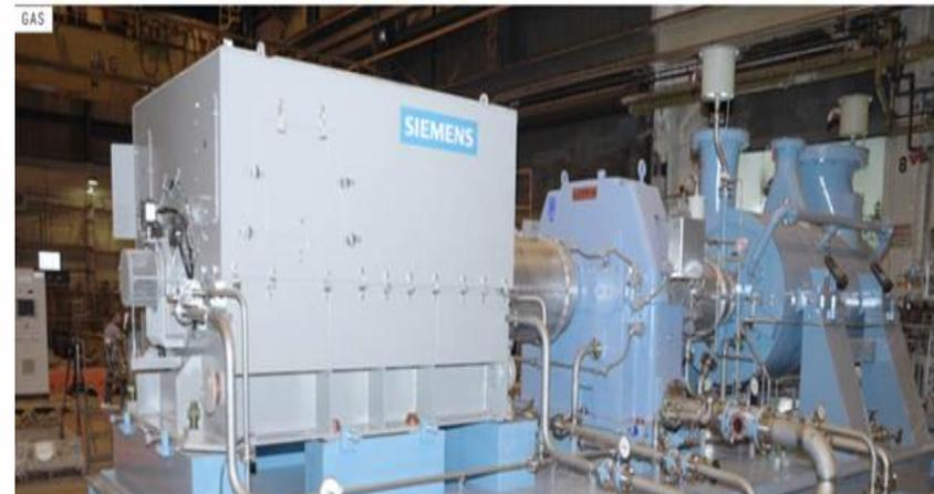
Compresor con capacidad de manejo de 250 MMPCSD y una diferencial de presión de 30 bars
